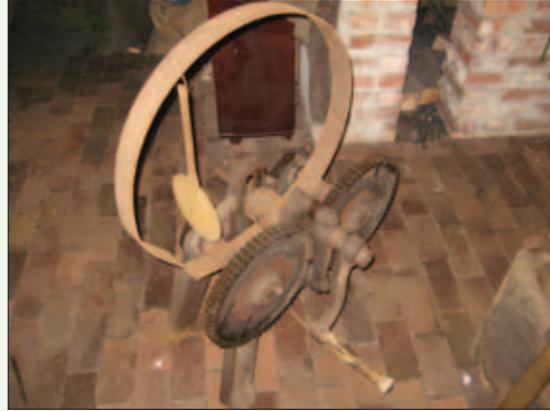
*Handbetätigte Maschine zum Biegen von Radreifen für den Beschlag von Holzrädern.*
