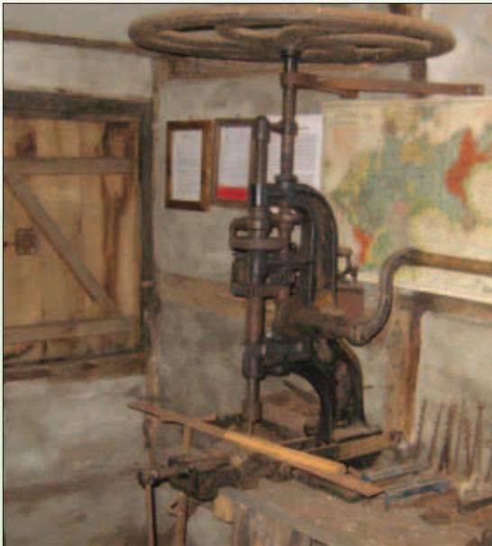
*Alte Bohrmaschine mit Handkurbel*
