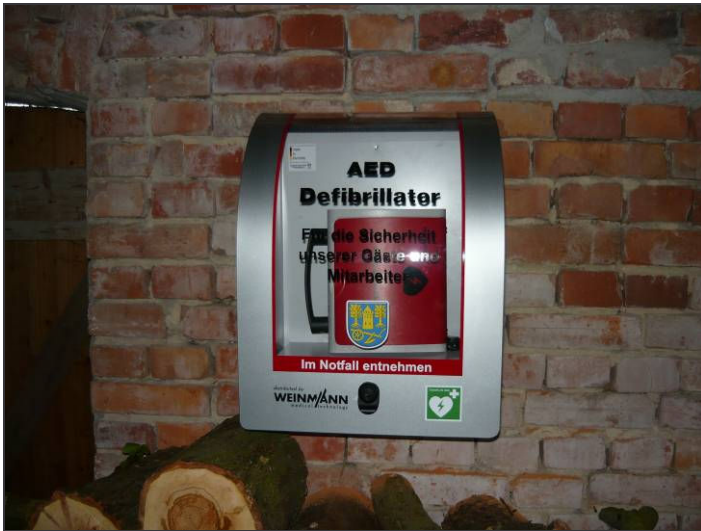
Gehäuse öffnen und den Defi entnehmen. Bei der Entnahme des Gerätes ertönt ein lautes akustisches Signal. Dieses kann im Ernstfall ignoriert werden und soll nur sicherstellen, dass eine unberechtigte Entnahme bemerkt wird.
